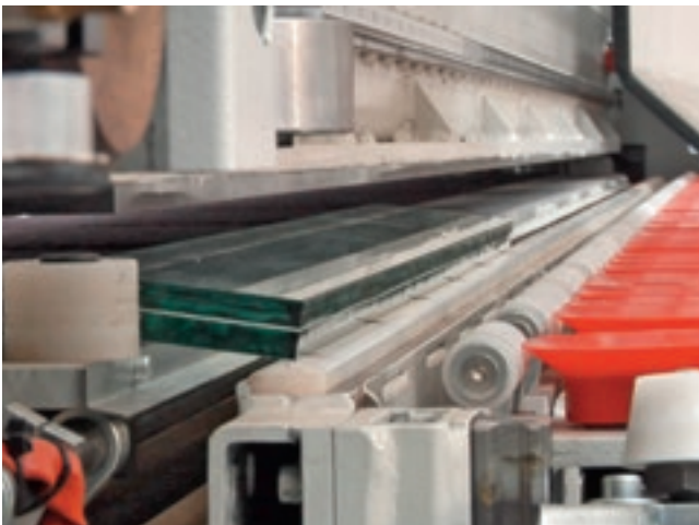
Standardmäßiges Schneiden + Brechen + Ablösen 60 mm.
