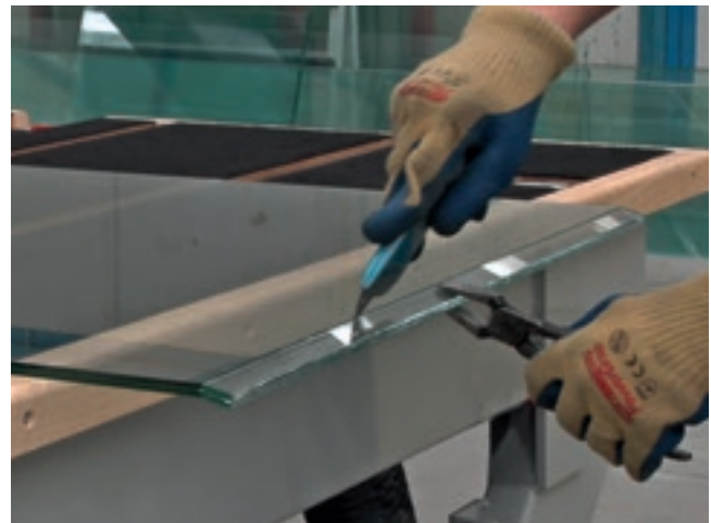
Automatisches Schneiden + Brechen + manuelles Ablösen 20 mm.
